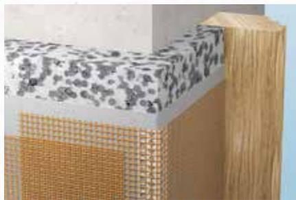
**1** Las aristas verticales serán protegidas mediante la instalación de Perfil Cantonera, adherida con el mortero cola o masilla de refuerzo, este cubrirá por completo el PVC de la cantonera y se retirará casi a 0 en el área de la malla hasta el PVC para recibir el espesor de la capa de armadura solapada sobre la malla de la cantonera hasta el PVC.
