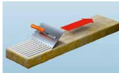
Cuando se instalan paneles de lana mineral sin imprimación, el proceso de aplicación del adhesivo se hará en dos pasos, el primero aplicando con llana el adhesivo a presión sobre el panel a modo de imprimación, en la zona de recepción del bordón y las pelladas o en la totalidad de la superficie para el encolado completo y el segundo fresco sobre fresco, aplicando el bordón y las pelladas o peineado con la llana dentada en el método de encolado completo.
