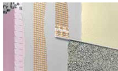
**8** En el área en contacto con el terreno, encima del revoco de acabado y hasta una altura aproximada de 5 cm sobre la cota del terreno como protección contra el agua por salpicaduras, puede aplicarse a brocha o cepillo Capatect- SockelFlex mezclado 1:1 con cemento y diluido un 5% con agua, o Capatect-SockelFlex Carbon diluido máximo un 10% con agua.
